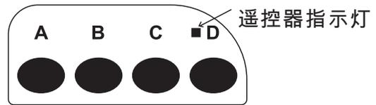
按住1秒遥控器的扫描键，遥控器指示灯会闪亮，显示器显示“扫描中：”字样松开，此时主机正在扫描中，读取完成后显示器会有提示音并显示扫描到的数量和震动器震动的次数。
