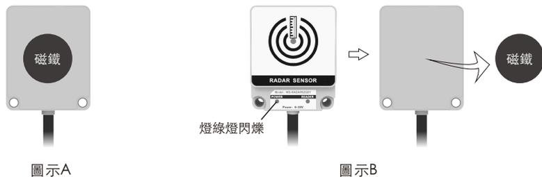
此時走到最遠測距位置對準本產品站立不動，觀察右邊指示燈顯示藍燈，再聽到” Bi、 Bi” 聲開始加速，直到發出” Bi” 長音便完成設定。
