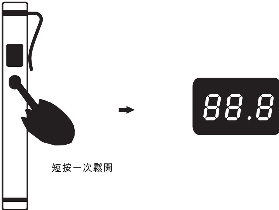
開機後如果沒有測量體溫的操作進入待機狀態，1.5秒後自動顯示環境溫度（注：如果測量過體溫操作後就不會再顯示）。
