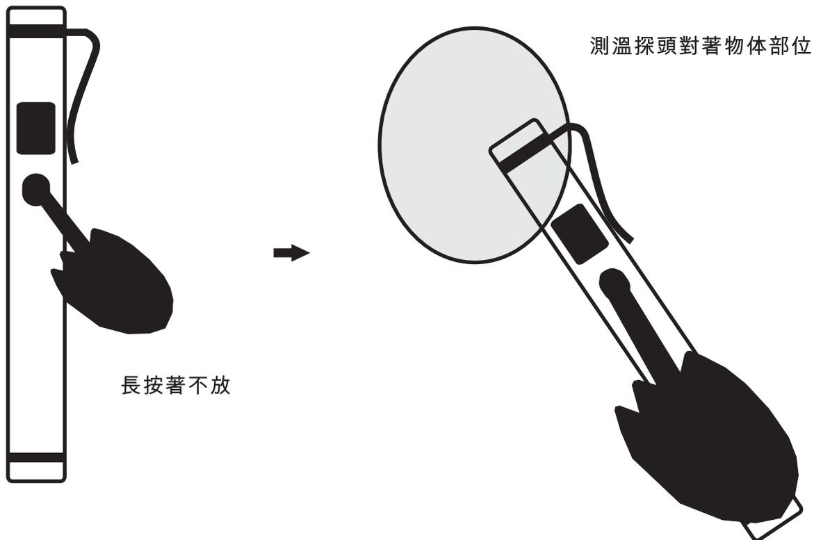
待聽到提示音後，表示測溫完成，鬆開按鍵，螢幕會顯示當前測量的溫度，在不操作情況下，螢幕會持續顯示改體溫15秒。
