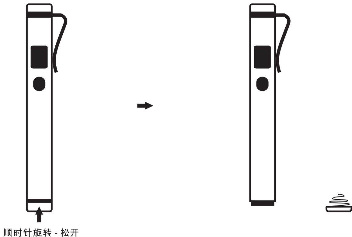
將電池裝入，正極先入，負極朝底，最後把電池蓋蓋好，逆時針旋轉擰緊即可。
